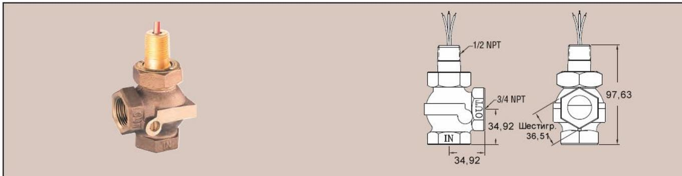
**Шаровое реле потока серии G9** обеспечивает точное детектирование потока в воде и нефти с повторяемостью  $\pm 1\%$ . Затворный байпасный клапан внутри корпуса управляется снаружи с использованием обычной отвертки, что позволяет настроить изменение потока. Каждое реле выполнено из коррозионноустойчивых материалов и противостоит ударам и вибрации. Серия G9 подходит для инициирования аварийных сигналов в блокирующих цепях, для защиты подшипников, редукторов и охлаждающих систем.
