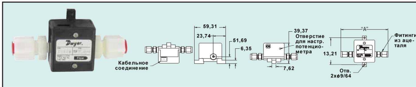
**Турбинные расходомеры жидкости серии TFP-LP** хорошо подходят для различных промышленных, коммерческих и лабораторных измерений потока. Эти приборы используют турбину и электрооптическое детектирование для преобразования расходов в линейный выходной сигнал величиной от 0 до 5 В пост. тока для его записи и накопления данных. Для дистанционного мониторинга потока устройство соединяется с Сумматором потока серии TM2. Для работы требуется адаптер питания или соединительный кабель.
