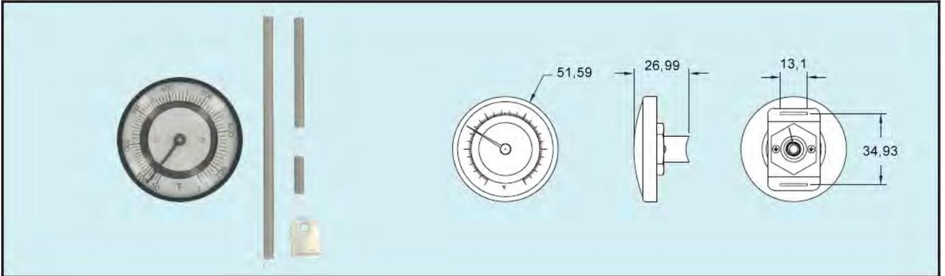
Биметаллические термометры для поверхности серии ВТР созданы для точного измерения температуры поверхности труб с размерами от 25 мм до 150 мм. Серия ВТР включает три размера пружины для надежной установки на поверхности трубы. Термометры с установкой на трубе удобны для временной установки и приложений, которые требуют измерения температуры без вмешательства в технологический процесс.
