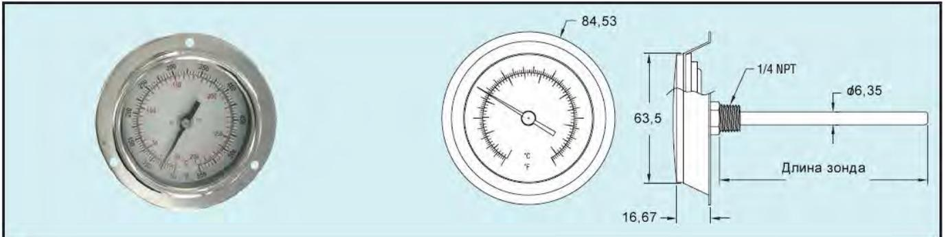
Биметаллические термометры для установки на поверхности серии ВТРМ созданы для легкой установки на большинстве приборных панелей. Передний фланец имеет три отверстия диаметром 4 мм для быстрого крепления термометра на панели. Термометр серии ВТРМ имеет шкалу 90мм со стойким стеклом. Термометры устанавливаемые на панели серии ВТРМ идеальны для HVAC (нагревание, вентиляция и кондиционирование воздуха), автомобильной и пищевой промышленности, химических процессов и др.
