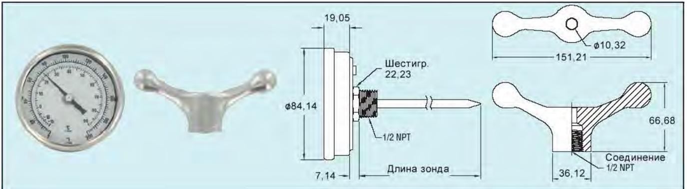
**Биметаллические термометр с длинными зондами серии BTLRN.** Термометры дальней досягаемости имеют доступные длины зондов от 30 см до 180 см. Большие цифры на 90 мм шкале легко читаются. Как дополнительное оборудование доступна рукоятка с захватом для удобства удержания термометра во время временных установок. Серия BTLRN идеальна для больших емкостей и воздушных каналов.
