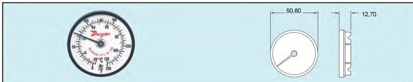
**Измерение температуры** бойлеров, воздушных каналов, двигателей, подшипников, печей и других поверхностей с помощью Термометров для установки на поверхности серии ST. Конструкция с двойным магнитом позволяет легко установить на любой ферромагнитной поверхности. Биметаллическая тепловая чувствительная катушка обеспечивает быстрое измерение температуры с точностью  $\pm 2\%$  от полной шкалы.
