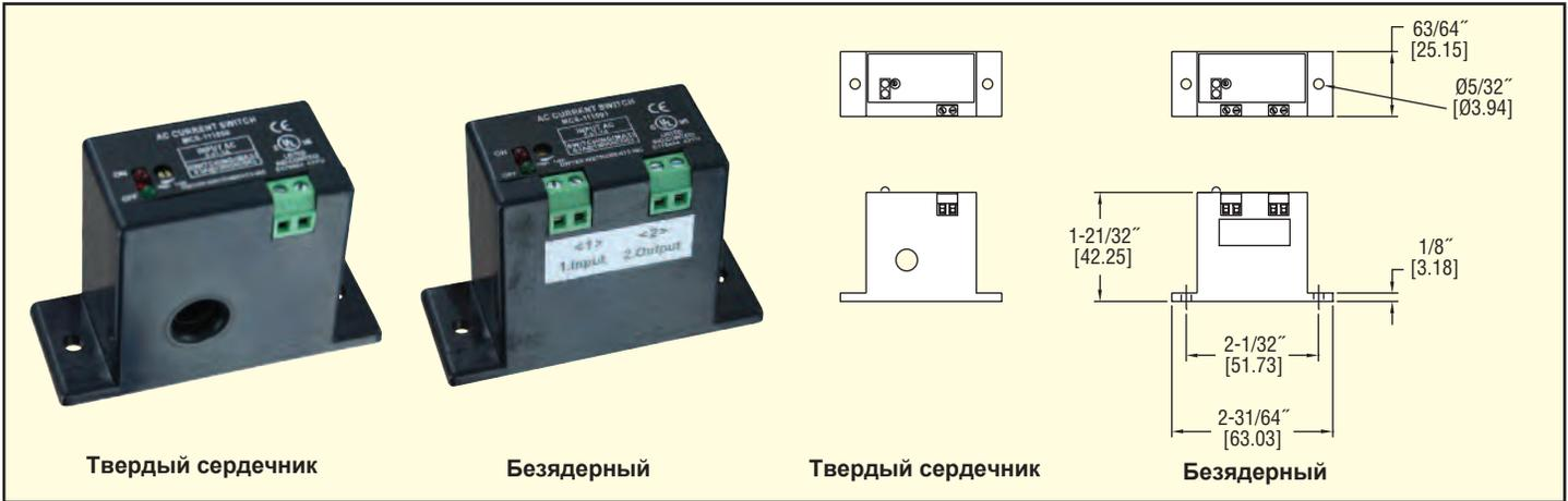
Серия MCS Миниатюрное реле тока идеально подходит для мониторинга тока в блоках предохранителей и небольших панелях управления. Обе модели имеют регулируемые точки уставки и светодиодный индикатор, чтобы показать имеется ли питание устройства и когда реле активируется. Заданные значения можно регулировать с помощью потенциометра рядом со светодиодами.
