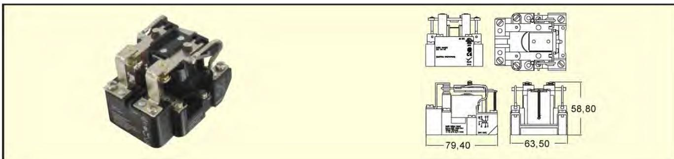
Реле мощности открытого типа серии 199 создано для приложений с высоким переменным и постоянным током до 40 ампер. Эти безртутные DPDT (двухполюсный переключатель на два направления) реле доступны для различных напряжений переключения и сопротивлений катушки, чтобы оно удовлетворяло большинству обычных приложений. Заклепанная конструкция корпуса увеличивает прочность и уменьшает воздействие вибрации на реле.
