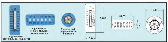
Необратимые температурные индикаторы серии KS являются идеальным решением для мониторинга и контроля температуры в специфических условиях, таких как, климатические условия во время хранения и транспортировки. Индикаторы производятся для различных температурных зон и надолго темнеют при выдержке их, при указанной температурной точке или выше ее. Индикаторы самоклеящиеся и стойки к воздействию масла, воды и пара, что позволяет быстро и легко поместить их на любой гладкой поверхности.
