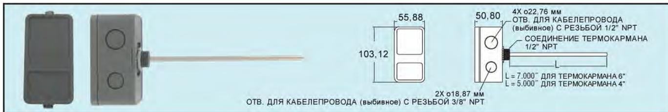
Погружаемый сенсор температуры общего применения серии I2-2 является идеальным для мониторинга линий горячей и холодной воды в зданиях или цеховых помещениях. Пластиковый корпус выполнен в форме стандартной соединительной коробки с несколькими выбивными отверстиями, служащими для облегчения установки кабелепровода. Сенсор серии I2-2 может заказываться с выбором 11 опций, которые позволяют его использовать с любой стандартной системой управления.
