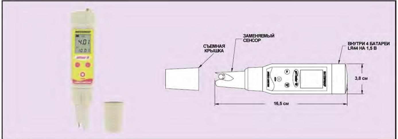
**Водостойкий тестер pH карманного размера серии WPH.** Сенсор на основе заменяемого двойного спая содержит колбу pH из стекла для защиты. Большой 4-цифровой дисплей легко читается и имеет разрешение до 0,01 pH. Серия WPH имеет автоматическую температурную компенсацию и может заказываться с двойным дисплеем для pH и температуры.
