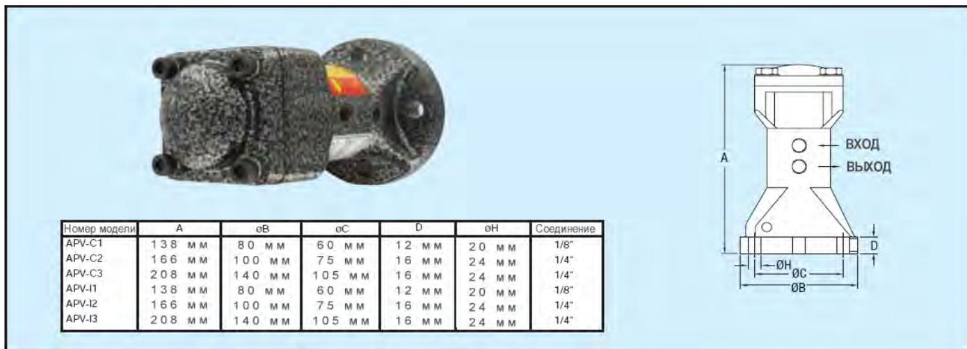
**Поршневые вибраторы серии APV-C** являются воздушно-амортизированными для обеспечения низкого уровня шума. Это делает их пригодным для малозумных приложений. Эта серия является хорошим решением для предотвращения образования отложений на стенках резервуара и предупреждения проблем с подачей материала. Она также может применяться в вибрационных сепараторах и конвейерах.
