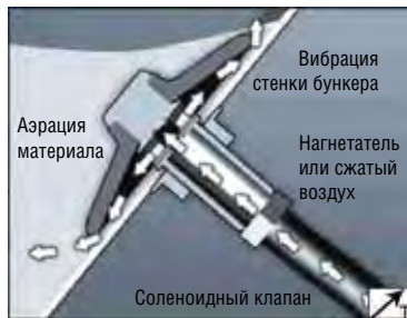
Дисковый флюидизатор показан в работе на разрезе бункера
